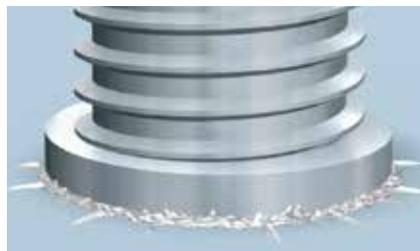
Die Schmelzonen erstarren. Der extrem kurze und saubere Schweißvorgang erfordert keine Nachbearbeitung.
