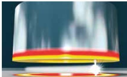
Ein brennender Lichtbogen wird definiert in Rotation versetzt. Dadurch entsteht ein ringförmiges Schmelzbad, in das das Schweißelement eingetaucht wird.
