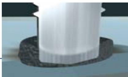
Das Ergebnis ist eine gleichmäßige Verbindung von sehr hoher Festigkeit, die über der des Grundwerkstoffes und des Bolzens liegt.
