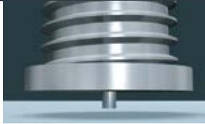
Verbinden von bolzenförmigen Schweißelementen mit dem Durchmesser M3 - M10 ( $\varnothing$  2 - 10 mm) auf dünnen Blechen, min. 0,5 mm. Stahl (unlegiert und legiert), Aluminium und Messing.
