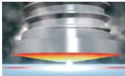
Anschließend erfolgt die Zündung des Hauptlichtbogens. Bolzen und Werkstück werden angeschmolzen. Der Bolzen wird zum Werkstück bewegt. Beide Schmelzzonen vereinigen sich.
