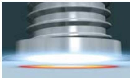
Beide Teile werden dadurch angeschmolzen, mit geringer Fügekraft zusammengeführt und miteinander verbunden.
